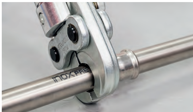
Ilustracja 37 – Wykonywanie połączenia zaprasowanego
