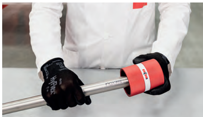
Ilustracja 27 – Stępanie krawędzi rury
